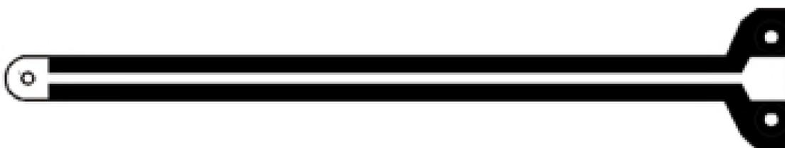
**Рисунок 6 – Планка-держатель индуктивного датчика**
