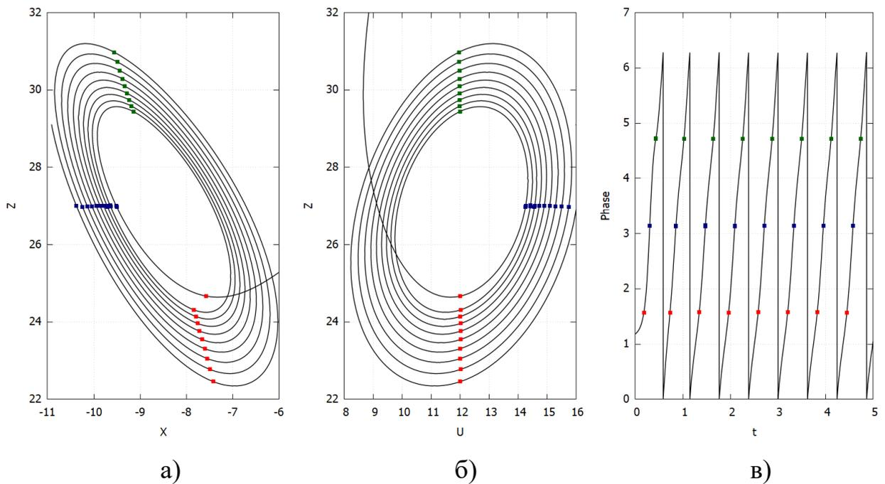
Рис.6. Рисунки к расчету фазы хаотических колебаний: а) фазовая траектория в плоскости  $(x, z)$ ; б) фазовая траектория в плоскости  $(u, z)$ ; в) график зависимости фазы колебаний от времени. Точки одинакового цвета соответствуют точкам с близким значение фазы. Красным цветом отмечены точки для  $\theta = \frac{\pi}{2}$ , синим для  $\theta = \pi$ , зеленым для  $\theta = \frac{3}{2}\pi$
