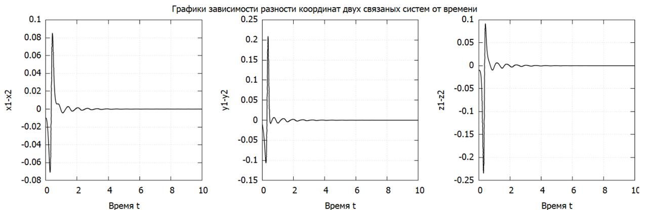
Рис.5. Зависимость разности координат двух связанных систем  $x_1 - x_2$ ,  $y_1 - y_2, z_1 - z_2$  от времени  $t$  при значении параметра связи  $E = 0,5$ .
