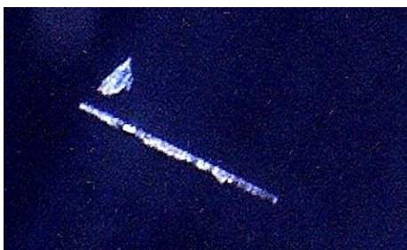
Рис. 8. Свечение в зазоре катод-анод при токоотборе с катода 900 \text{ А/см}^2
