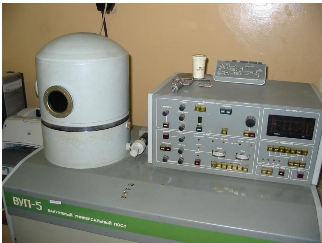
Рис.5.6 Внешний вид установки ВУП-5(Вакуумный Универсальный Пост)
