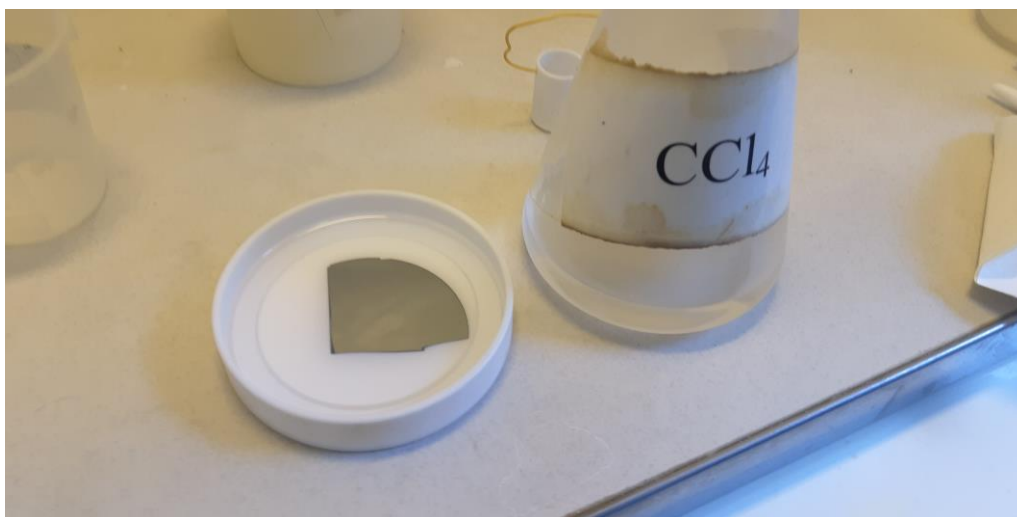
Рис.5.2 Обезжиривание пластины кремния в четыреххлористом углероде(тетрахлорметан)
