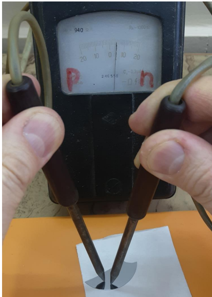
Рис.5.4 Определения типа проводимости полупроводника на основе эффекта термо-ЭДС
