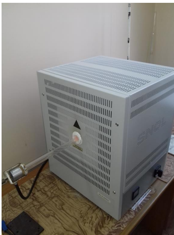
Рис.5.5 Нанесения оксида кремния в сухом кислороде.
