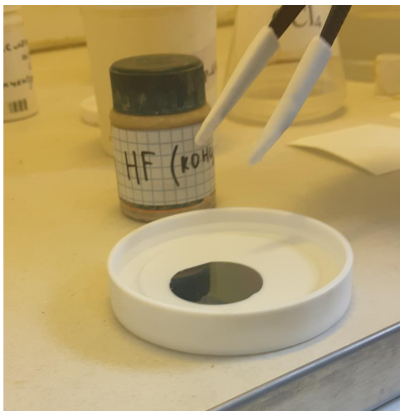
Рис.5.3 Снятие естественной пленки оксида кремния с поверхности пластины.
