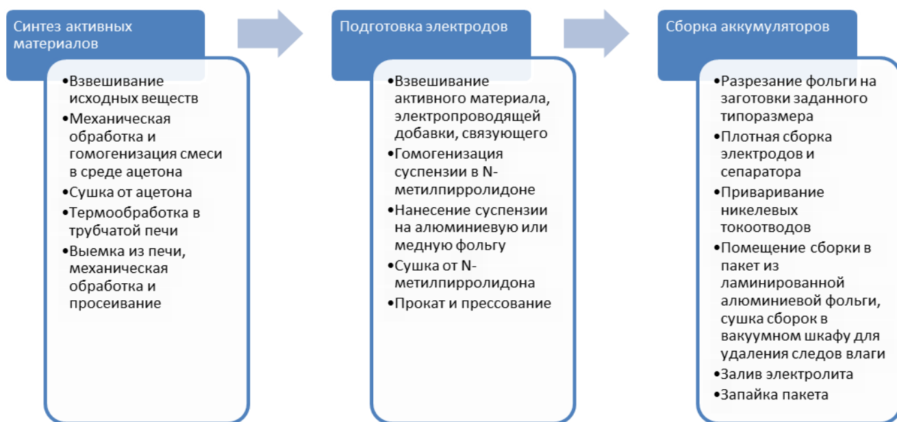
Рисунок 1 — Этапы производства литий-ионного аккумулятора.
