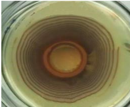
Рисунок 4 – Изображение распределения осадка хромата серебра при концентрации \text{AgNO}_3 = 0,5 моль/л и концентрации \text{K}_2\text{Cr}_2\text{O}_7 = 0,014 моль/л
