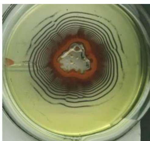
Рисунок 3 – Изображение распределения осадка хромата серебра при толщине геля равного 3 мм
