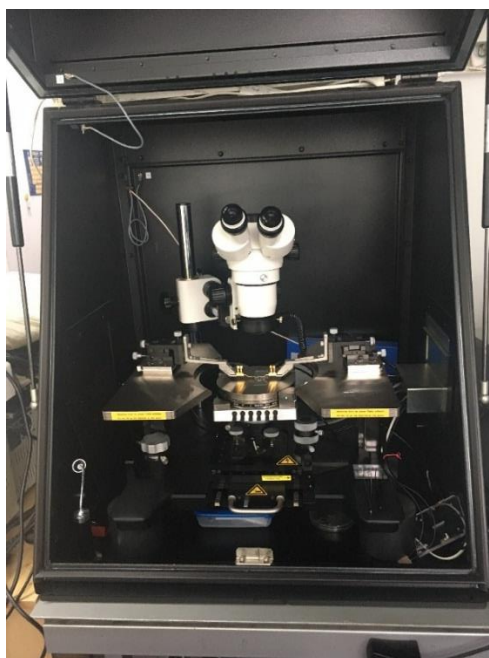
Рисунок 3 – Внутренний вид зондовой станции Cascade Microtech EPS150TESLA
