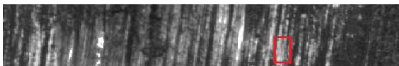
Рисунок 6 – Слияние трасс во вторичном следе исследуемой пули
