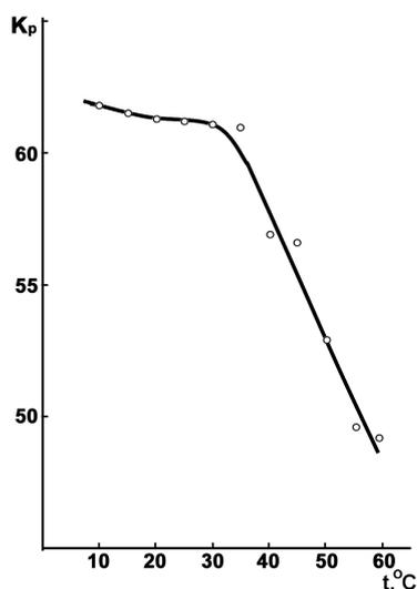
**Рисунок 2.4.3.** - Зависимость коэффициента распределения масляной кислоты от температуры в системе хлорид натрия – вода – масляная кислота
