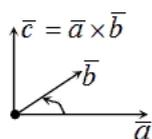
Рис. 3.2- Векторное произведение двух векторов
