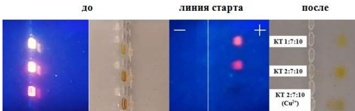
Рисунок 2 - Электрофореграмма образцов КТ с различным молярным соотношением реагентов (1,2 до подачи тока, 3,4 после)
