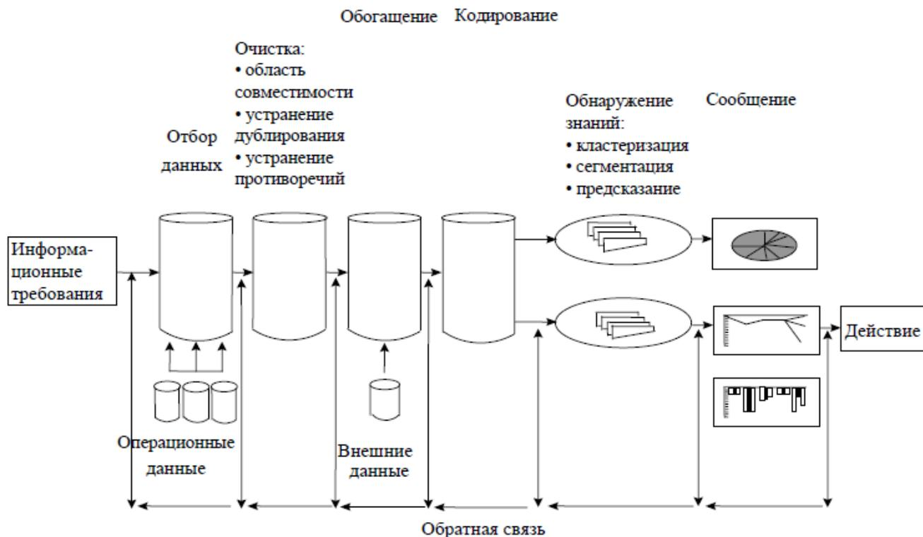
Рисунок 4 – Процесс обработки данных
