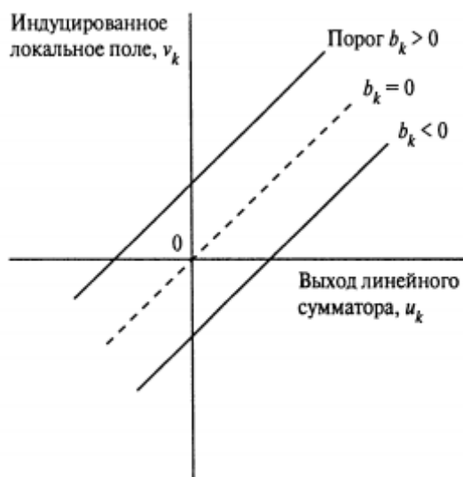
Рис. 2. Аффинное преобразование, вызванное наличием порога.
