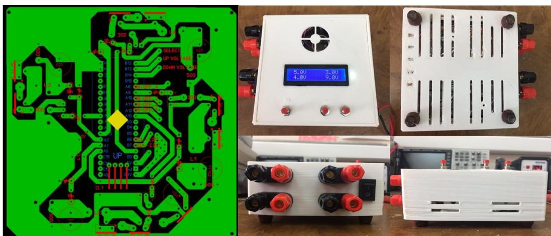
Рис. 10. Печатная плата и собранное устройства регулируемого преобразователя на базе МК STM32F103CBT8.
