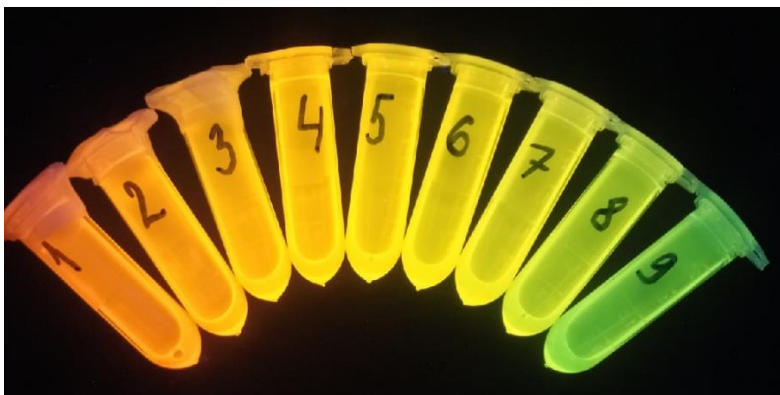
Рисунок 2. Фракции КТ под УФ-излучением ( \lambda_{\text{возб.}}=365 нм).
