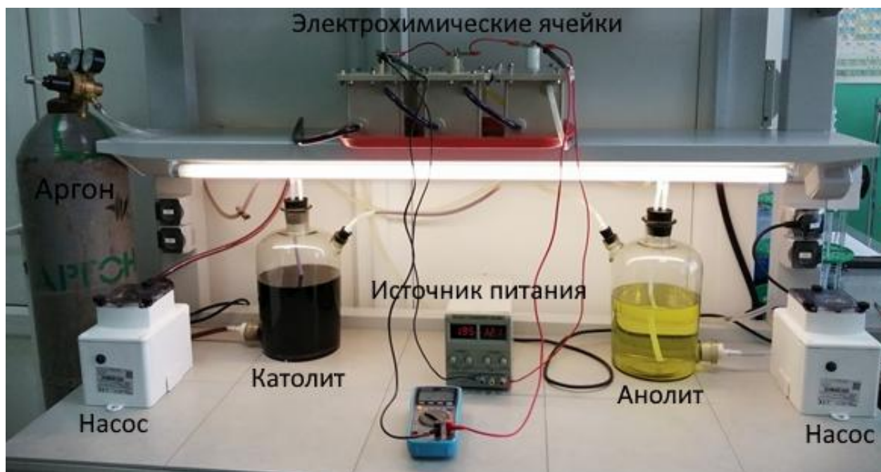
Рисунок 2 - Фотография лабораторного макета редокс-проточной батареи с тремя рабочими ячейками
