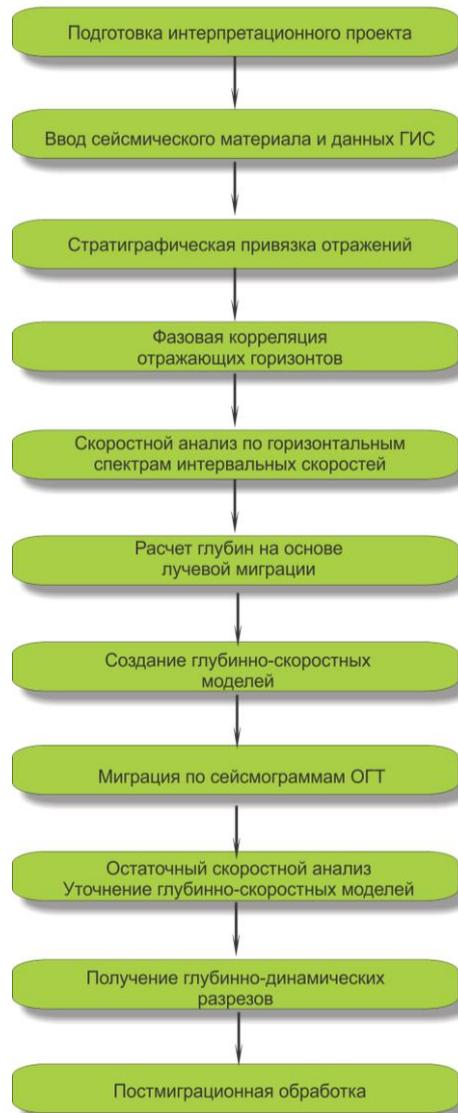
Рисунок 4 - Граф обработки с использованием глубинной миграции до суммирования
