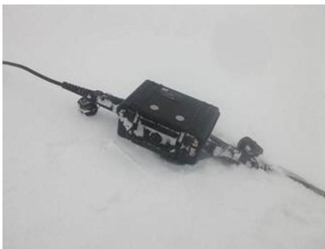
Рисунок 2 - Электроразведочный излучатель из комплекта аппаратуры «БИКС».
