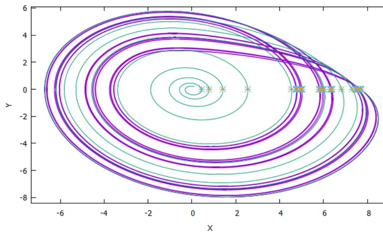
Рисунок 8 - Проекция фазового портрета с сечением Пуанкаре методом Такера (оранжевый) и сечением Пуанкаре методом Эно (синий) на плоскости  $(x, y)$  при значении параметров  $a=0.2$ ,  $b=0.2$ ,  $r=4.2$ .
