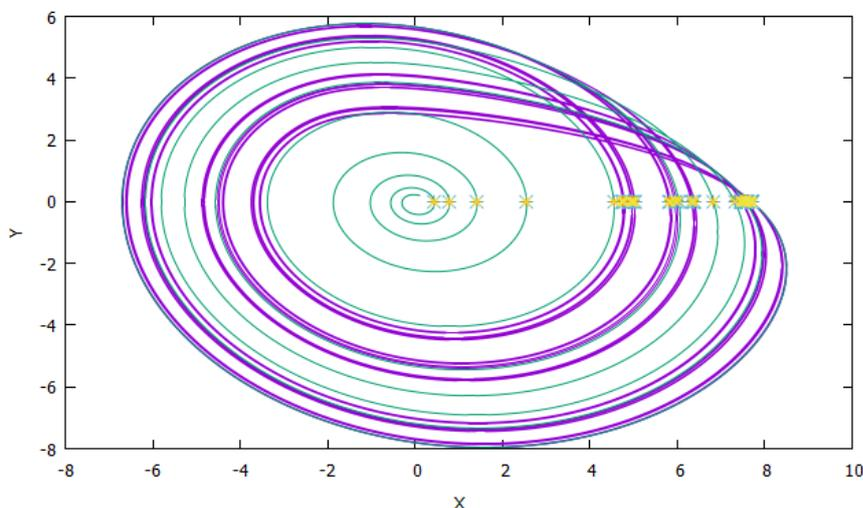
Рисунок 4 - Проекция фазового портрета с сечением Пуанкаре со средней точкой (желтый), сечением Пуанкаре методом Эно (синий) и сечением Пуанкаре простейшим методом (оранжевый) в плоскостях  $(x, y)$ , при значении параметров  $a=0.2$ ,  $b=0.2$ ,  $r=4.2$ .
