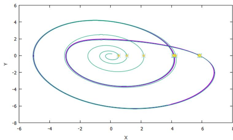
Рисунок 2 - Проекция фазового портрета с сечением Пуанкаре со средней точкой (желтый), сечением Пуанкаре методом Эно (синий) и сечением Пуанкаре простейшим методом (оранжевый) в плоскостях  $(x,y)$  при значении параметров  $a=0.25$ ,  $b=0.2$ ,  $r=3$ .
