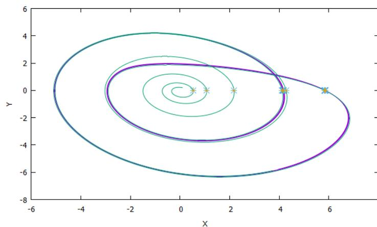
Рисунок 6 - Проекция фазового портрета с сечением Пуанкаре методом Такера (оранжевый) и сечением Пуанкаре методом Эно (синий) на плоскости  $(x, y)$ , при значении параметров  $a=0.25$ ,  $b=0.2$ ,  $r=3$ .
