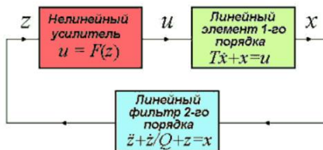
Рисунок 1 - Классическая схема генератора Дмитриева-Кислова
