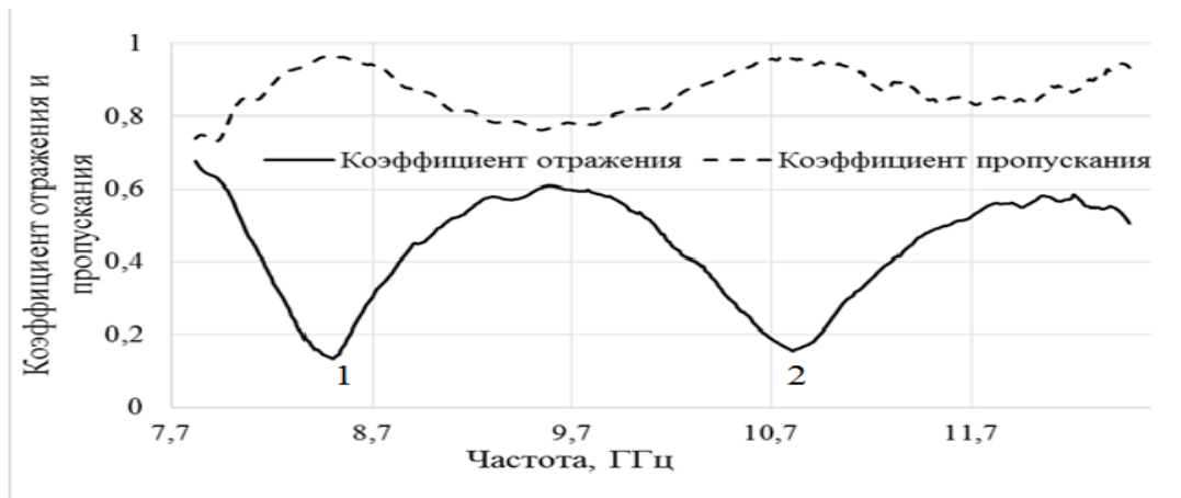
Рисунок 11 – График зависимости коэффициента отражения и пропускания от частоты. Длина структуры 37,7 мм, коэффициент заполнения 100 % :1 – первый минимум, 2 – второй минимум.
