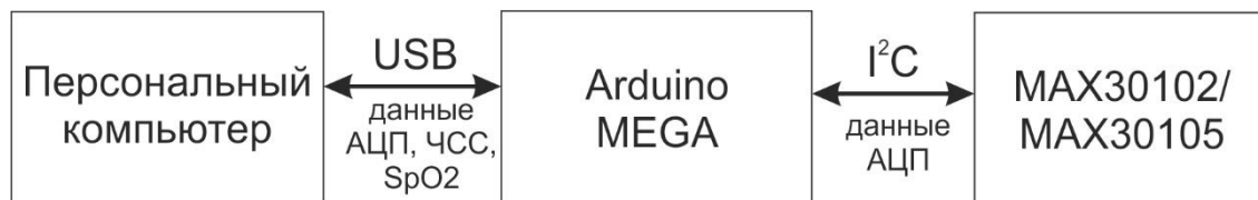
Рисунок 1 – Схема макета установки для экспериментального исследования и расчета сатурации крови.
