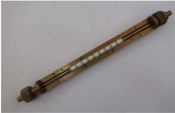
Рис. 2 Измерительная секция сверхвысокочастотной КБС
