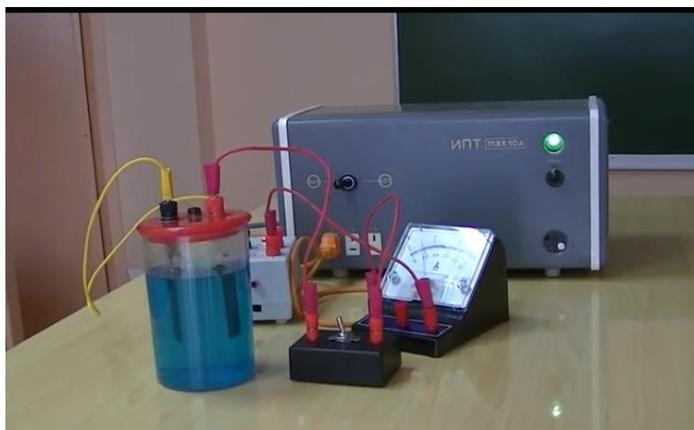
Рисунок 2 – Демонстрация химического действия электрического тока
