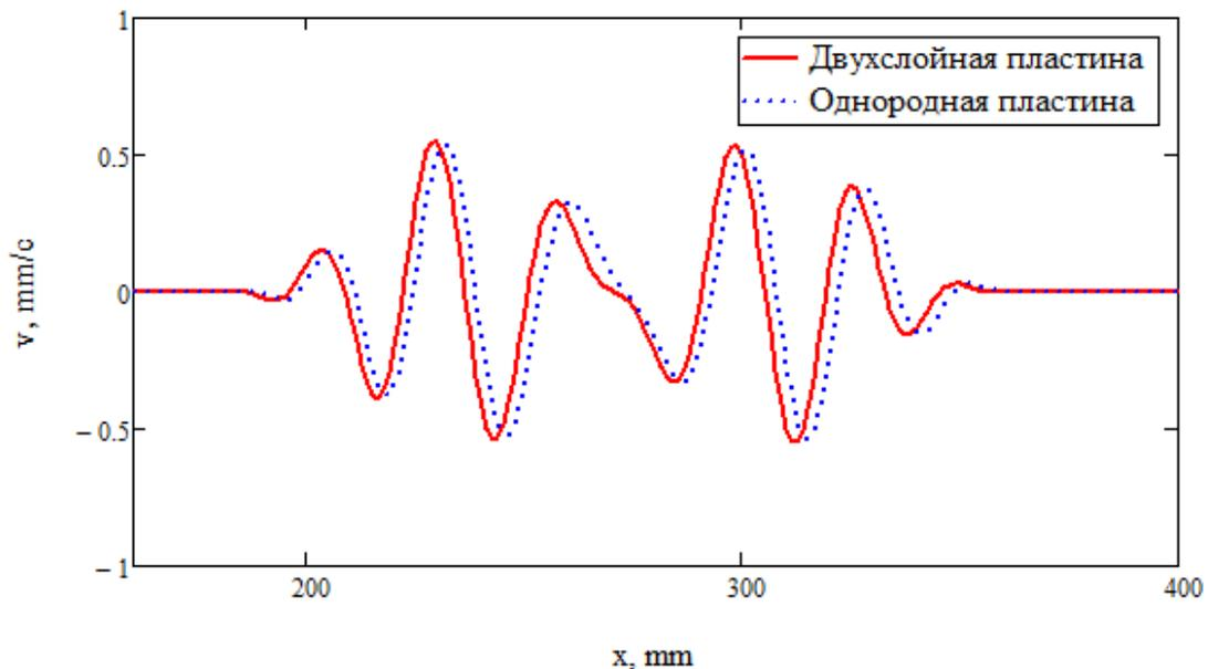
Рисунок 4 – Сравнение профилей волны при уменьшении модуля Юнга на 20% в слое толщиной 0.2 мм
