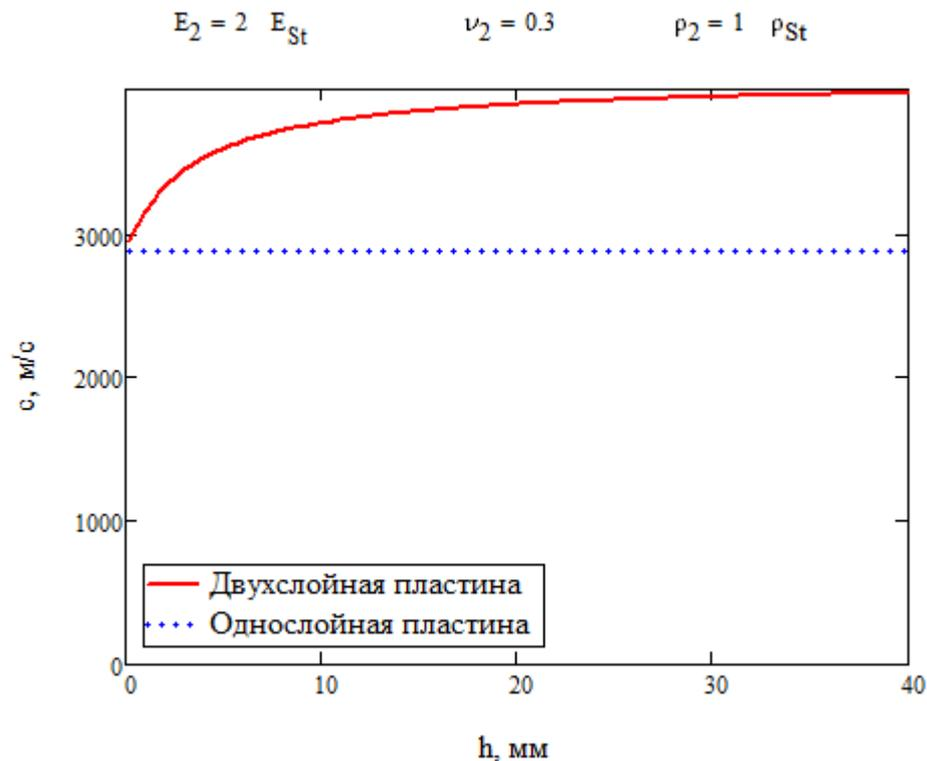
Рисунок 3 – Двухслойная пластина с модулем Юнга второго слоя в 2 раза больше, чем первого
