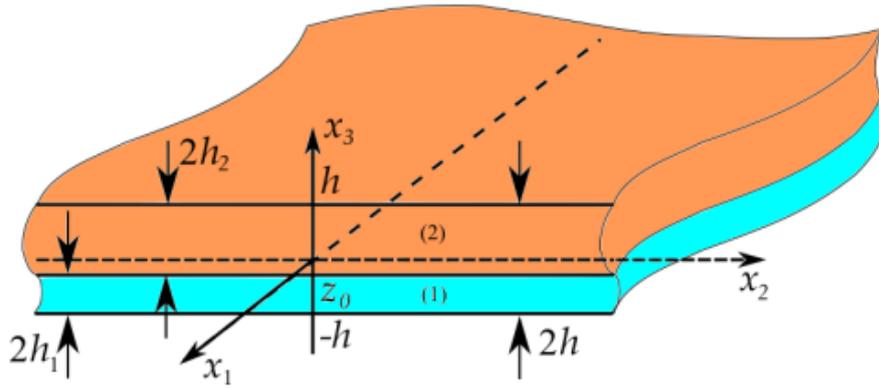
Рисунок 2 – Полубесконечная двуслойная пластина
