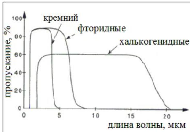
Рисунок 2 – Пропускание ИК - излучения в оптических стёклах
