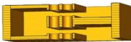
Рисунок 5. Один период замедляющей системы типа «петляющий волновод» [1].
