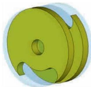
Рисунок 4. Один период замедляющей системы типа «цепочка связанных резонаторов» [2].
