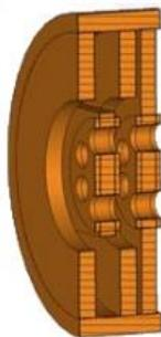
Рисунок 3. Один период замедляющей системы типа «сдвоенная лестница» с втулками [1].
