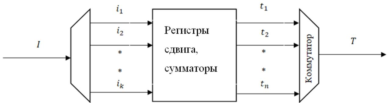
Рисунок 4 – Сверточный кодер в общем виде
