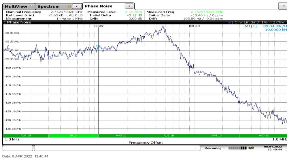
Рис. 14. Измерения уровня фазового шума.
