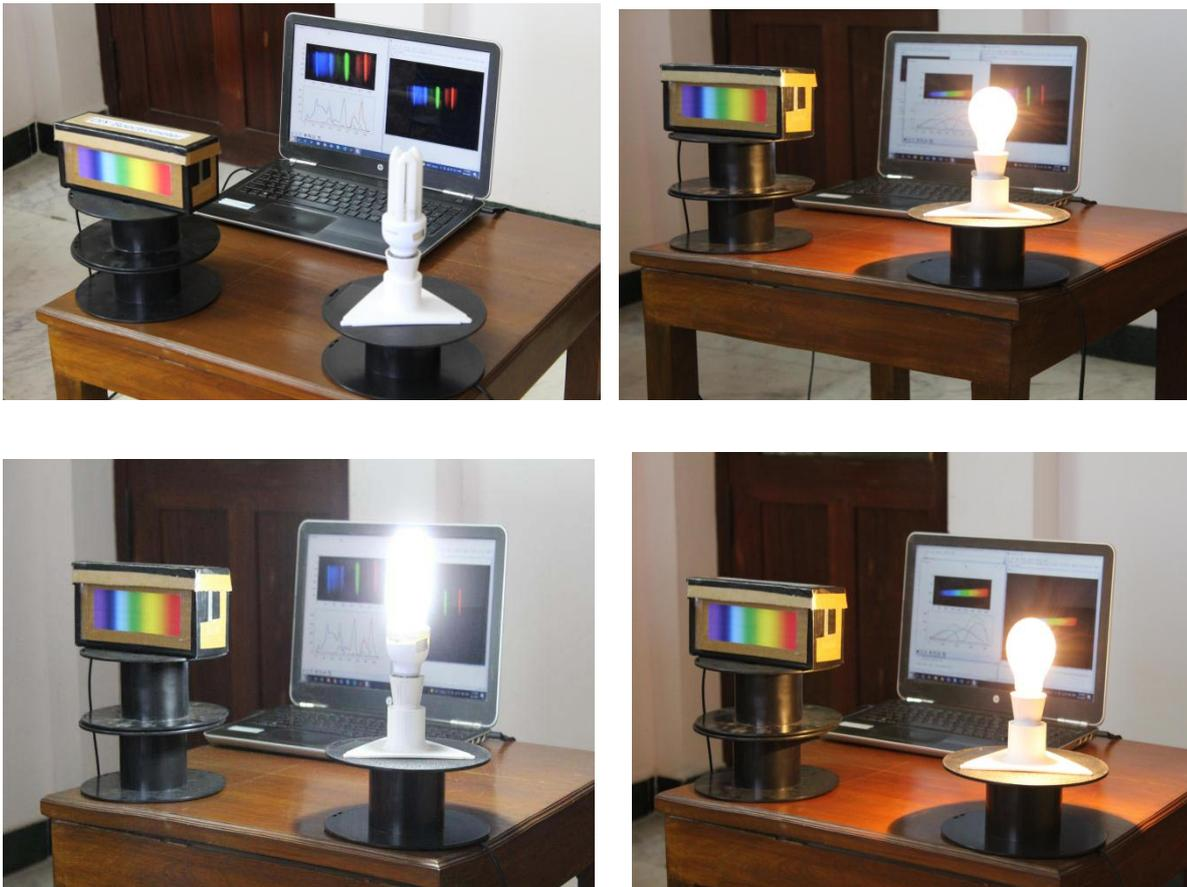
Рис. 10. Установка спектрометра для светового анализа образцов.
