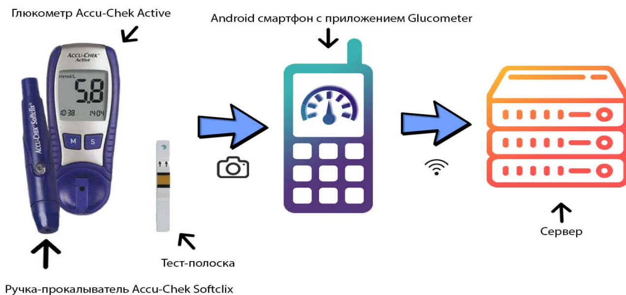
Рисунок 1 - Блок схема телемедицинского комплекса
