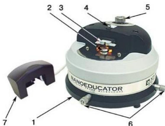
Рисунок 2 – Внешний вид измерительной головки СЗМ NanoEducator 1 – основание, 2 – держатель образца, 3 – Датчик взаимодействия, 4 – винт фиксации датчика, 5 – винт ручного подвода, 6 – винты перемещения сканера с образцом, 7 – защитная крышка с видеокамерой [3]
