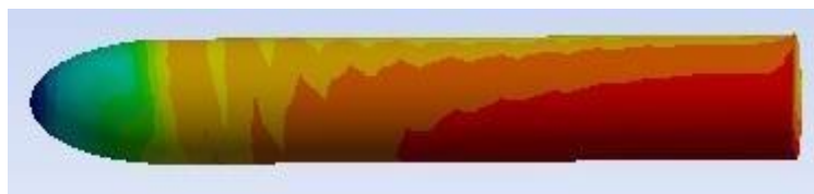
Рисунок 10 – Поле напряжений винта с виртуальной резьбой
