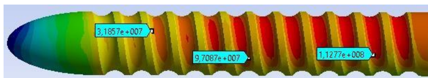
Рисунок 12 – Точечные значения напряжений на винте с трехмерной резьбой
