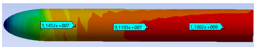
Рисунок 13 – Точечные значения напряжений на винте с виртуальной резьбой
