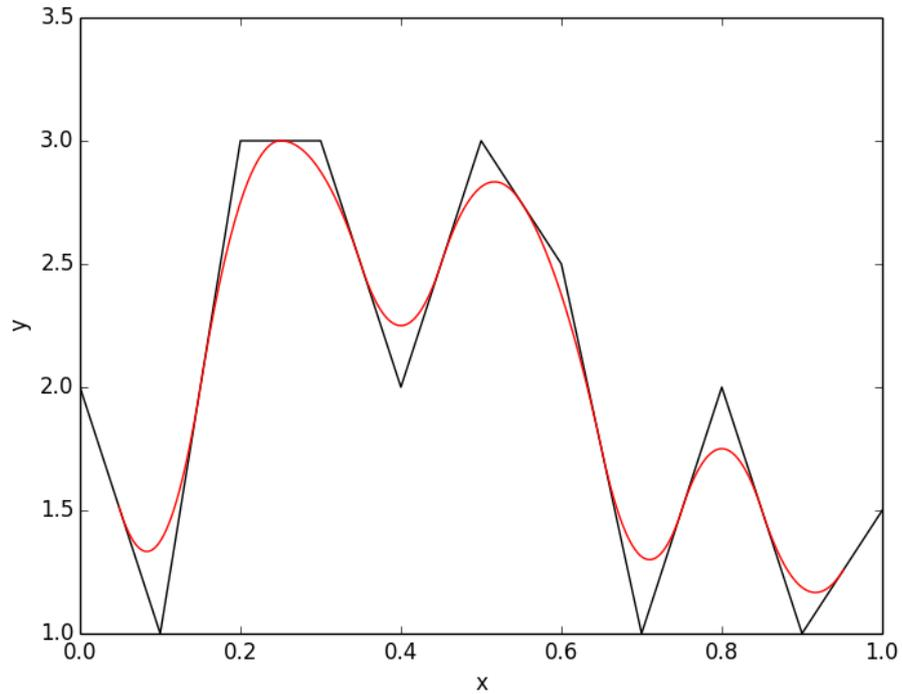
Рисунок 8 – Реализация алгоритма двоичного базисного сплайн 2-ой степени
