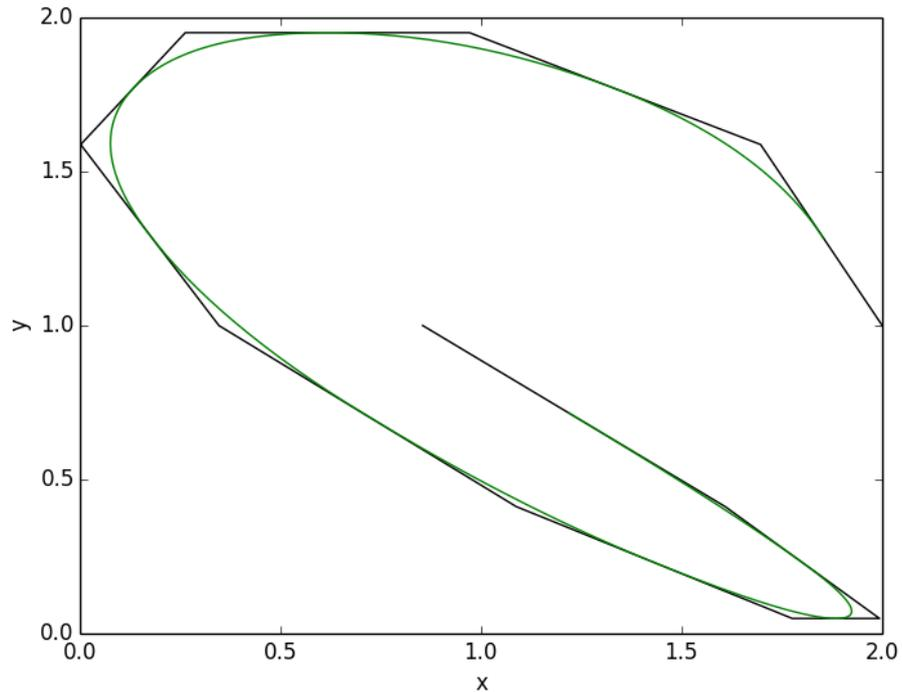
Рисунок 9 – Реализация алгоритма двоичного базисного сплайн 2-ой степени при  $m_x = 1.99999998$ ,  $m_y = 0.9999989$
