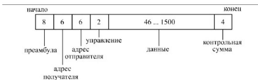
Рисунок 1 — Структура кадра Ethernet II
