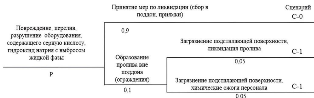
Рисунок 2 – «Дерево событий» по аварии «Повреждение, перелив, разрушение оборудования, содержащего серную кислоту, гидроксид натрия»
