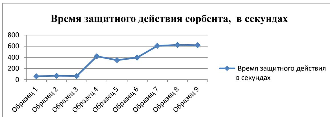
Рисунок 2 – Время защитного действия адсорбента
