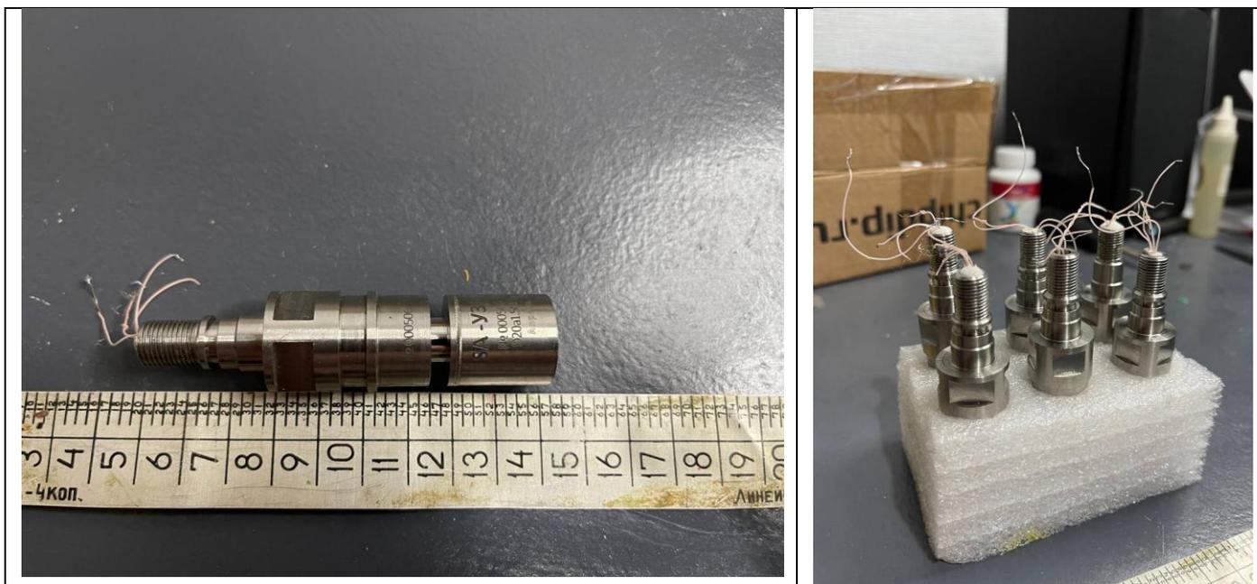
Рисунок 1 - приемопередатчики «SA-УЗД130Т»
