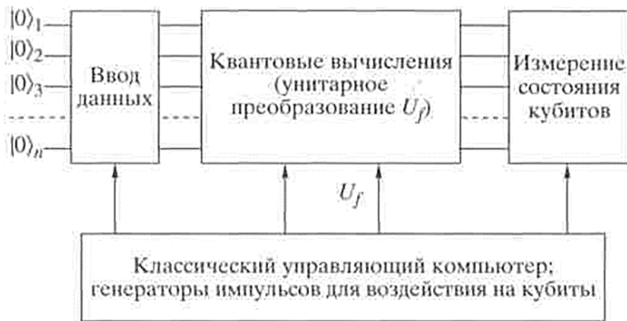
Рис.2 Квантовый компьютер, состоящий из n кубитов и позволяющий проводить одно- и двухкубитовые операции над любым из них или любой парой).
