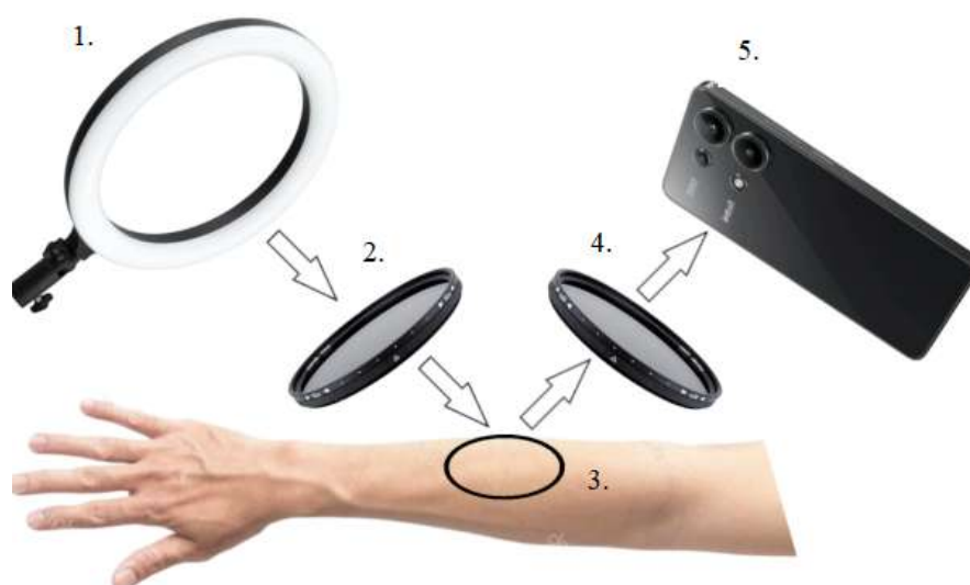
Рис. 1. Экспериментальная установка. (1 – осветитель; 2 – поляризатор, крепится на осветитель; 3 – объект, рука добровольца с нанесенным ОПА; 4 – поляризационный объектив для камеры смартфона; 5 – камера смартфона;).
