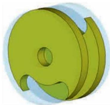
Рис. 4. Один период замедляющей системы типа «цепочка связанных резонаторов» [3].
