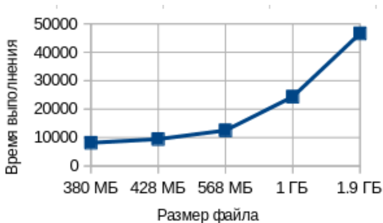
Рисунок 2. Зависимость времени работы однопоточной программы на Go, от размера файла данных
