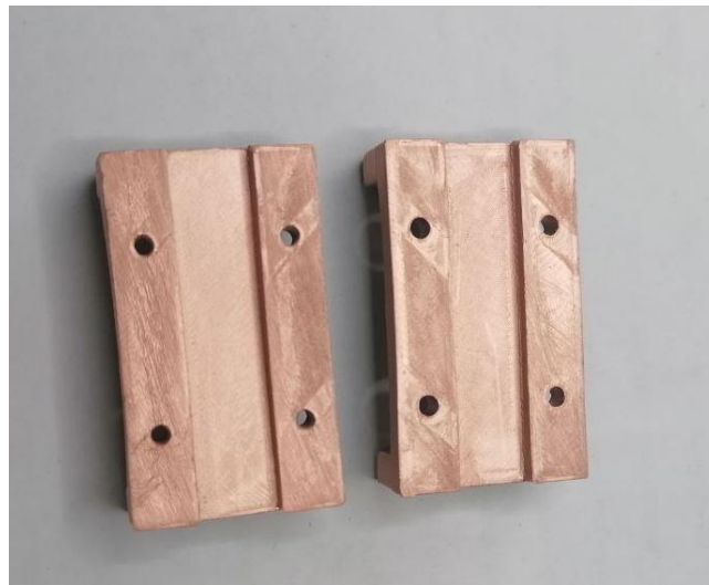
Рисунок 12 – Половины волновода в канале 16×8 с медным напылением, которые напечатаны из пластика HIPS методом послойного наплавления
