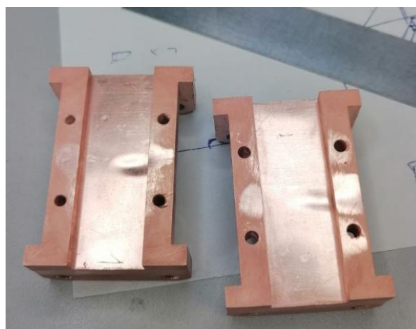
Рисунок 13 – Половины волновода, которые напылили в канале 16×8, которые напечатаны из пластика TR250 LV методом фотополимерной печати
