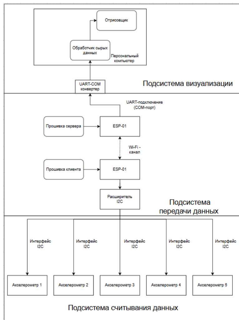
Рисунок 3 – Структурная схема разрабатываемой системы с разделением на подсистемы
