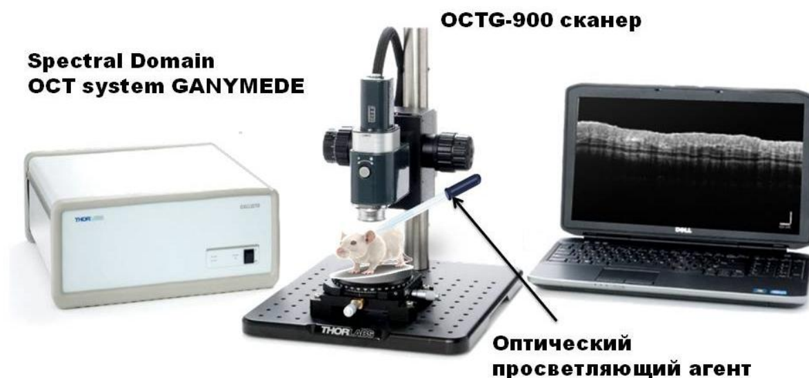
Рисунок 2 - Схема экспериментальной ОКТ установки
