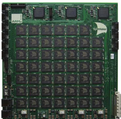
Рисунок 2. Пример аппаратной спайковой нейронной сети - печатная плата SpiNNaker с 48 узлами.
