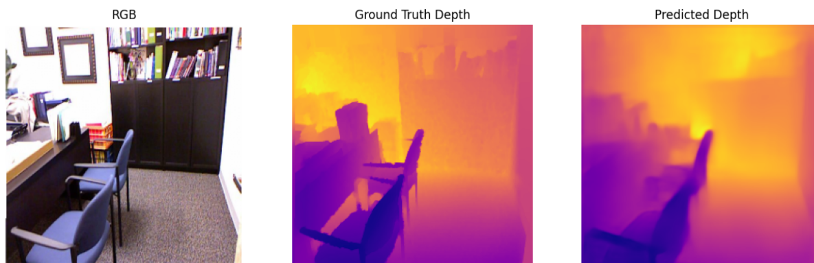
Рисунок 1 – Предсказанная карты глубины с помощью MiDaS
