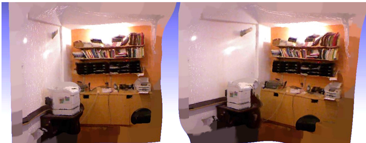
Рисунок 3 – Предсказанная карты глубины с помощью MiDaS
