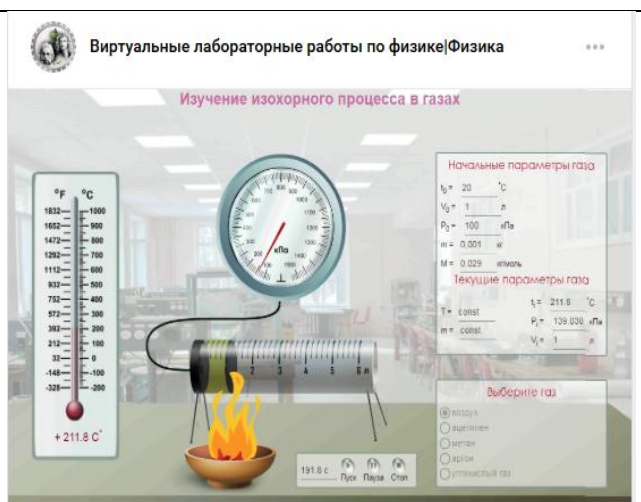
Рисунок 3 – Изучение изохорного процесса на виртуальной модели
