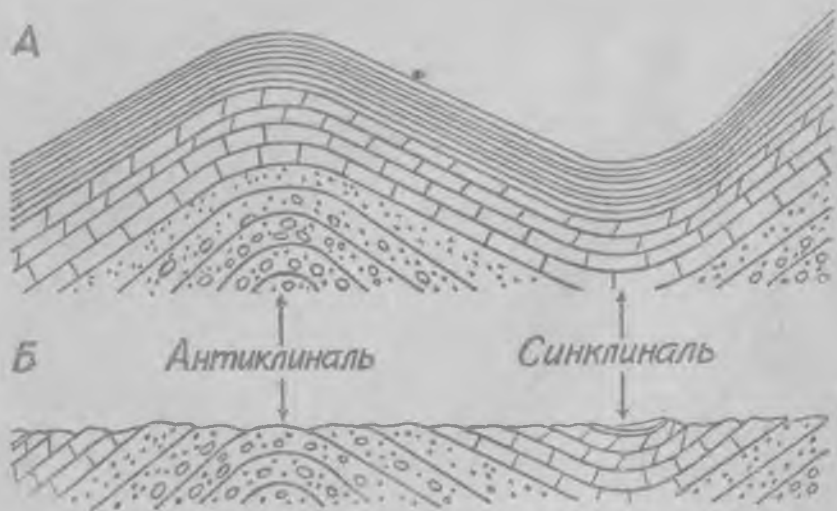
А. Антиклинальная и синклинальная складки. Б. Та же местность, превращенная размывом в равнину. На поверхность выходят в антиклинали более древние слои, в синклиналях—более молодые.
