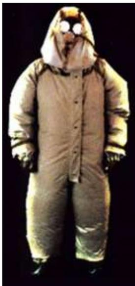
Рис. 87. Защитный изолирующий комплект с вентилируемым подкостюмным пространством Ч-20 СДЯВ. Кроме того, в комплект входят жилет и подшлемник из хлопчатобумажной ткани. Блок питания заряжается от сети через подзарядное устройство, которое также входит в комплект.
